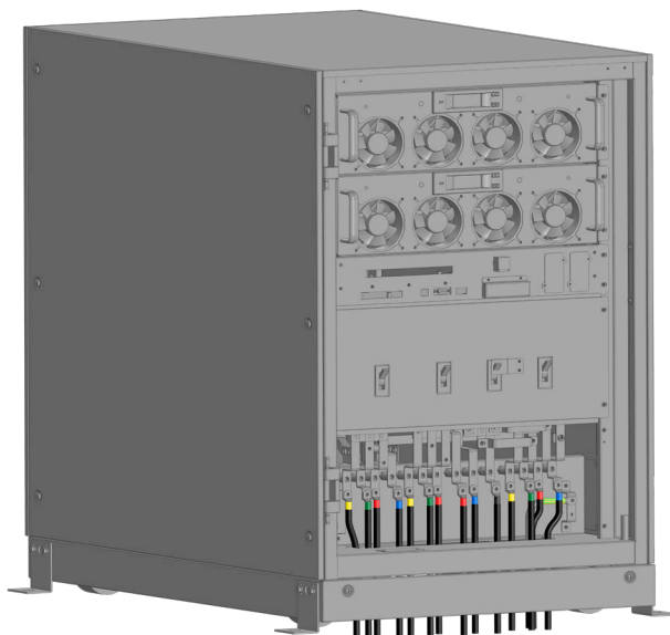
Рис. 3-10-1 Кабельный ввод 60 кВА - 200 кВА
