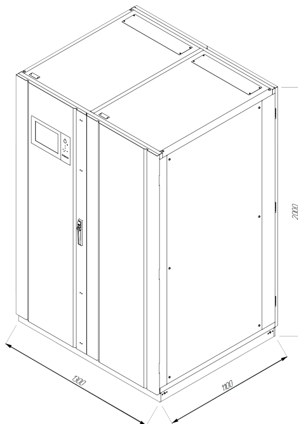
Рис. 3-2-6 Габариты ИБП 400кВА и 500кВА
