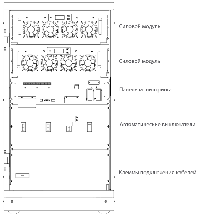
Рис. 2-8-3 Внешний вид 80 кВА и 100 кВА
